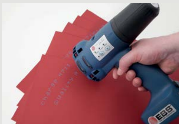
→ Nadruk na skórze (imitacja) niebieskim atramentem pigmentowym (MEK).
