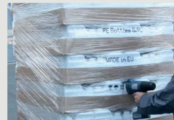
→ Nadruk na folii elastycznej czarnym atramentem uniwersalnym (etanol); duże rolki dystansowe.
