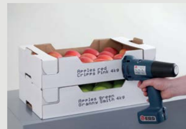
→ Nadruk na kartonie czarnym atramentem uniwersalnym (etanol).
