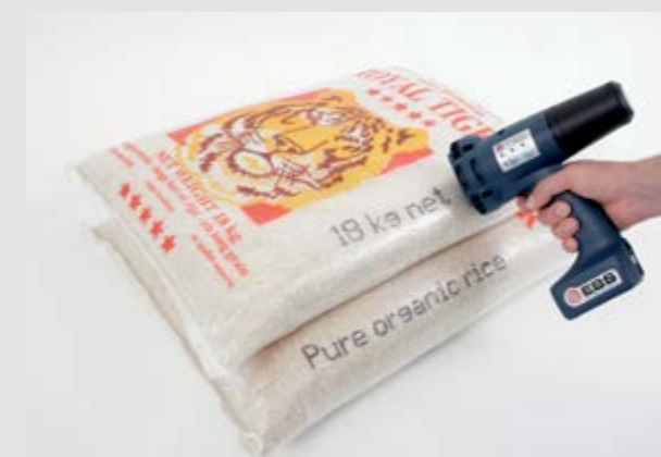
→ Nadruk na workach (PE) czarnym atramentem szybkoschnącym (aceton); duże rolki dystansowe.
