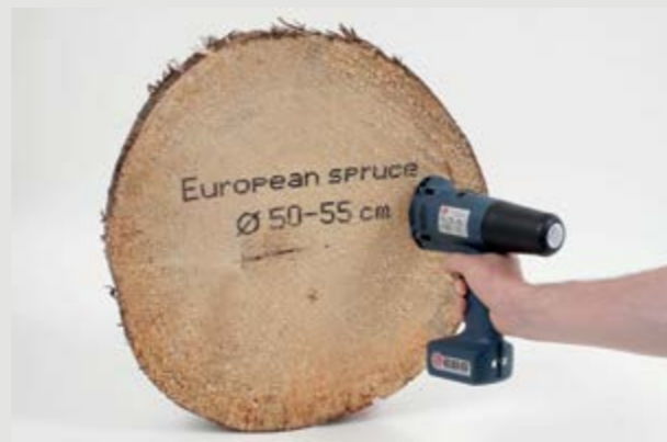
→ Nadruk na ciętym drewnie czarnym atramentem uniwersalnym (etanol); duże rolki dystansowe.
