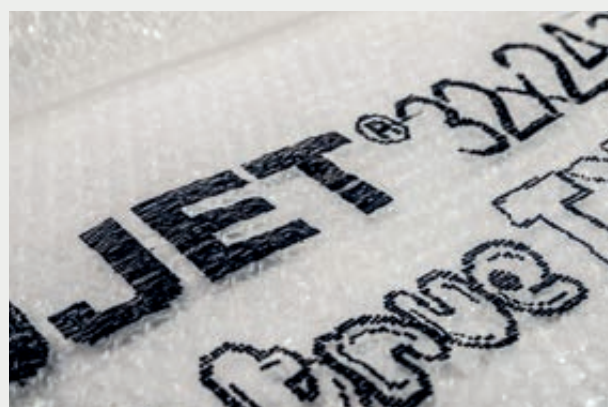
→ Czytelne nadruki na materiałach rozciągliwych, gładkich i porowatych, oraz na folii pęcherzykowej
