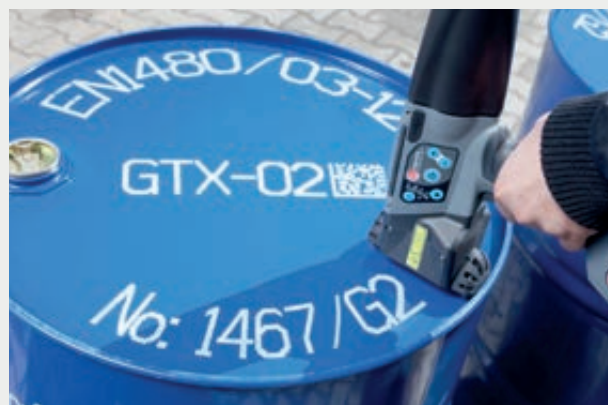
→ Szybkie oznakowanie beczek wieloma tekstami z grafiką, kodami 2D oraz licznikami (tzw. wierszowanie)
