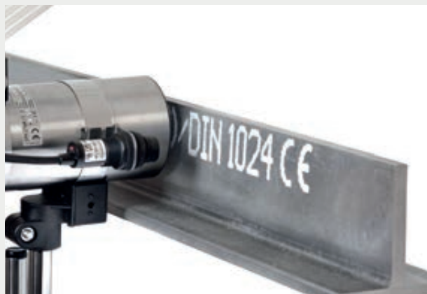
→ Nadruk na profilu metalowym
