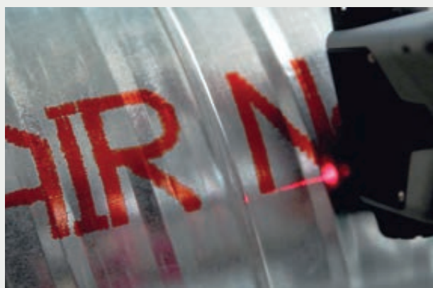
→ Drukowanie na karbowanych, metalowych rurach instalacji przemysłowych
