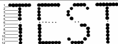
śruba regulacyjna przekręcona o 10 minut w lewo
