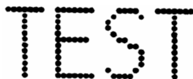
prawidłowo wyregulowane elektromagnesy
