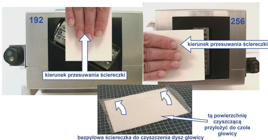
Rys. 6.2.2. Sposób wycierania czoła głowicy z dyszami ściereczką bezpyłową
